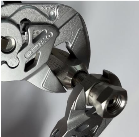
Abbildung 14 - Halten Sie an der Fassung gegen während Sie den Nippel einschrauben
