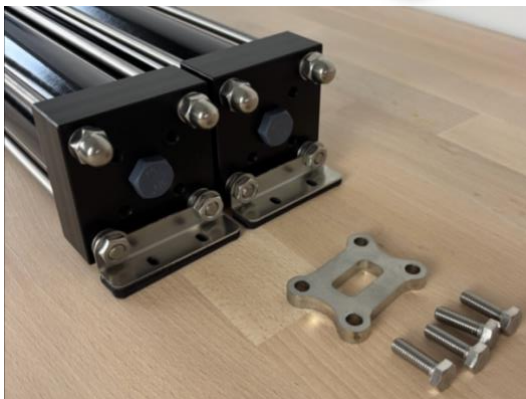
Abbildung 1 - Verbindung mehrerer Membrane
