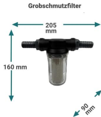
Abbildung 26 - Abmessungen Grobschmutzfilter
