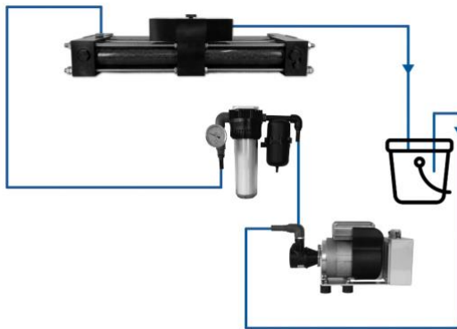
Abbildung3 – Wasserflussdiagramm für Konservierungs- und Reinigungsverfahren
