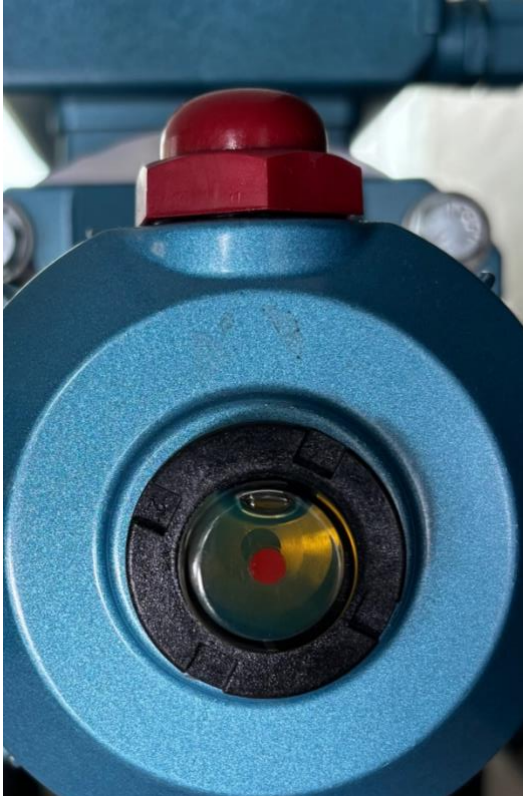
Abbildung 7 - Öfüllstand oberhalb des roten Markers für das Mindestniveau.
