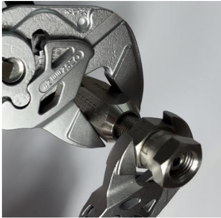
Abbildung 15 - Halten Sie an der Fassung gegen während Sie den Nippel einschrauben
