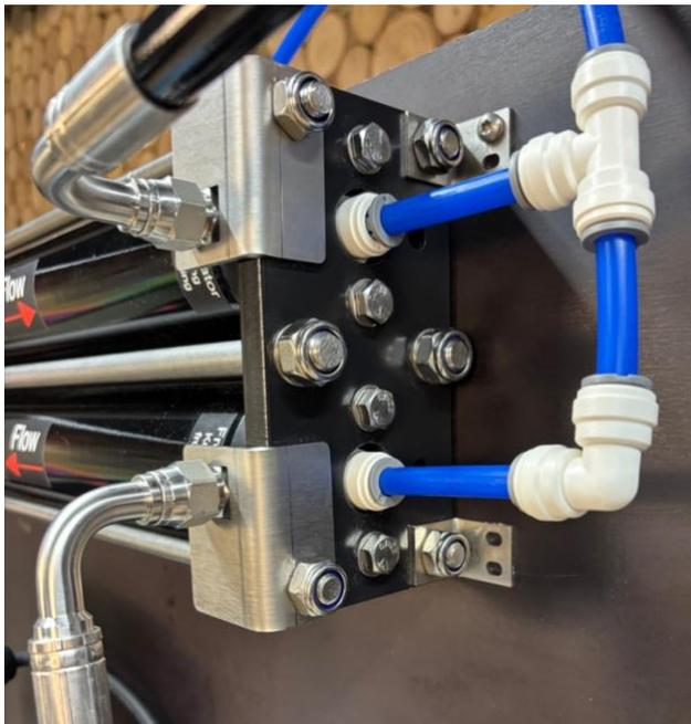
Abbildung 10 - Membraneinheit mit Anschlüssen für Seewasser und Produktwasser
