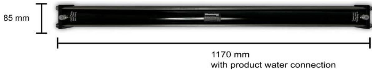
Abbildung 20 - Abmessungen Membraneinheit 1x2540
