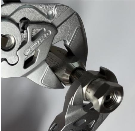
*Abbildung 14 - Halten Sie an der Fassung gegen während Sie den Nippel einschrauben*
