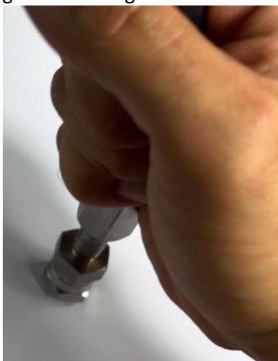
Abbildung 13 - Eindrücken des Nippels in den Schlauch mit vormontierter Fassung
