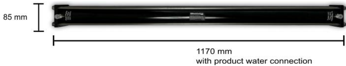
Abbildung 18 - Abmessungen Membraneinheit 1x2540
