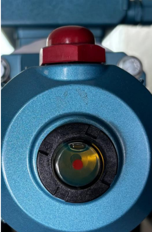
Abbildung 7 - Ölfüllstand oberhalb des roten Markers für das Mindestniveau.
