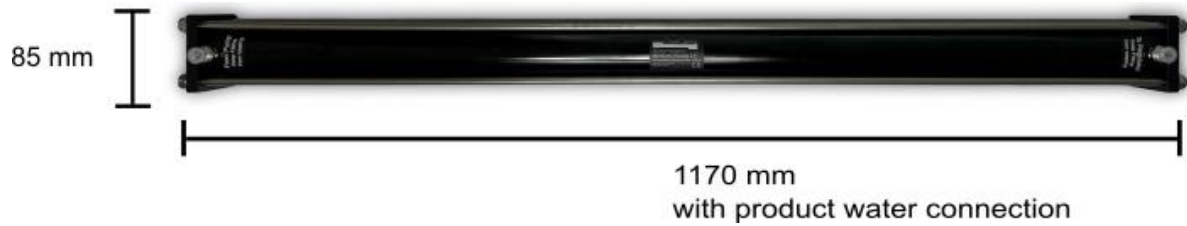
Abbildung 17 - Abmessungen Membraneinheit 1x2540
